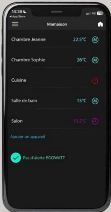
Le système **Home-SmartLink** utilise le smartphone de l'utilisateur du logement comme appareil central qui gère l'ensemble des informations des thermostats connectés **Home-SmartLink** de n'importe quel endroit de la maison. Il communique en direct par **BLE ( Bluetooth Low Energy )** avec les thermostats régulant l'émission de chaque émetteur de chaleur selon les consignes.
